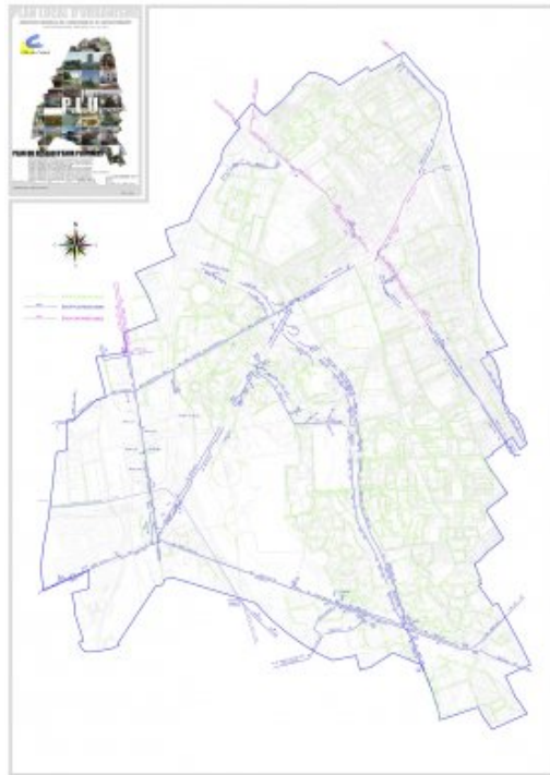
PLU - Plan du réseau d'eaux pluviales - décembre 2014
